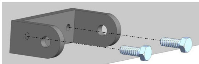
Insérer et bloquer le guide pré-monté sur le support antérieur
