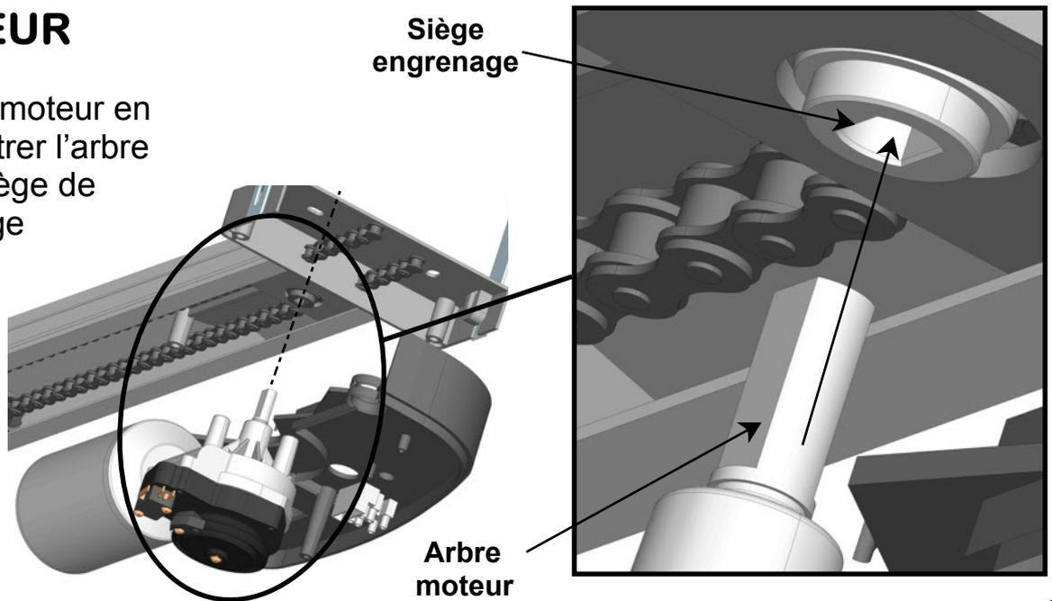
Fixer le moteur avec le trois vis autoforeuses
